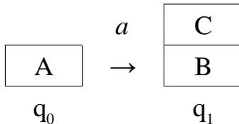
Sur un dessin d'automate, où l'on indique déjà à l'aide d'une flèche qui sont l'état de départ et l'état cible, on peut simplement noter la transition " $a \mid A, BC$ " :
