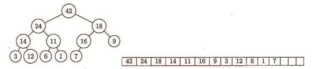
Les indices des tableaux commencent à 1. Si i est la position d'un nœud ayant un fils droit et un fils gauche, alors 2i est la position de son fils gauche et 2i+1 est la position de son fils droit. Aussi, si i est la position d'un nœud différent de la racine, alors  $\lfloor \frac{i}{2} \rfloor$  est la position de son père.
