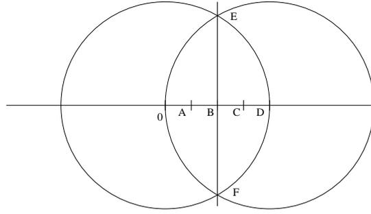
Figure 3: On trace les cercles de centre  $O$  et de centre  $D$  et de même rayon, égal à 1 unité de longueur. On note  $E$  et  $F$  les deux points d'intersection entre ces deux cercles. On trace la droite passant par ces deux points : on remarque qu'elle passe par  $B$ . On vient de tracer la droite passant par  $B$  et orthogonale à la droite passant par  $O$  et  $D$ .
