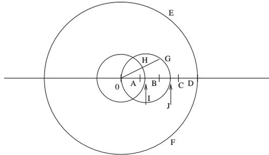
Figure 7: Il ne nous reste plus qu'à tracer la droite passant par le point  $I$  et orthogonale à la droite passant par  $O$  et  $D$ . Celle-ci s'obtient en construisant d'abord le point  $J$ , intersection du cercle centré en  $I$  et qui a pour rayon la distance  $OI$ . Ainsi  $I$  est exactement au milieu des points  $O$  et  $J$ .
